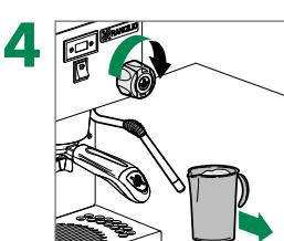
Terminata l'erogazione desiderata, chiudere il rubinetto e rimuovere il bricco. Pulire la lanza con un panno umido
