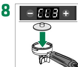
8 Quando il display mostra CL3, rimuovere il portafiltro e inserire nuovamente la membrana filtro cieco
