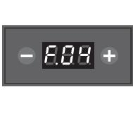
Per svuotare la caldaia vapore, posizionare un contenitore sotto la lancia acqua, scegliere **F.04** nei menu e confermare
