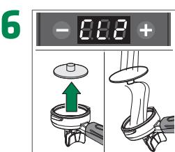
6 Quando il display mostra CL2, rimuovere il portafiltro con membrana filtro cieco e risciacquare entrambi con acqua
